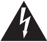
Le symbole de l'éclair avec une pointe de flèche à l'intérieur d'un triangle équilatéral met en garde l'utilisateur contre la présence de tension dangereuse, non isolée, à l'intérieur de l'appareil, dont l'amplitude peut être suffisante pour induire un risque d'électrocution d'une personne.
